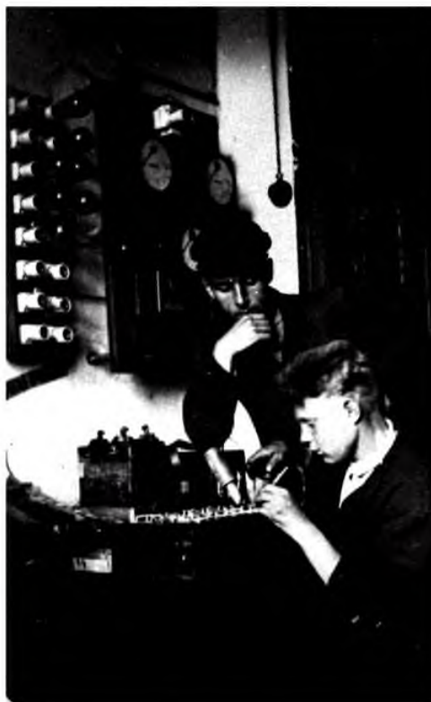
Ремонт счетчиков в лаборатории горэлектросети производят Богомалов и Ипполитов
