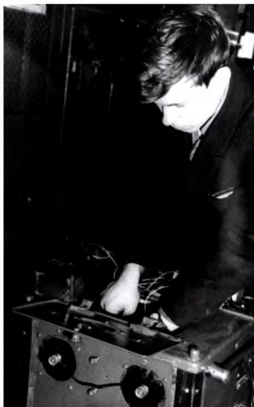
Ремонт аппарата по испытанию масла в лаборатории горэлектросети
