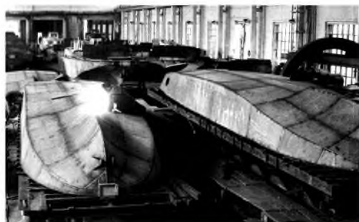
Полочная линия сборки катеров ПС-5 на судомеханическом заводе
