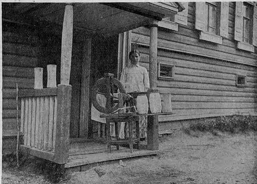
Рис. 8. Приборъ для разматки пряжи въ Кинешемскомъ уѣздѣ Костромской губ.
