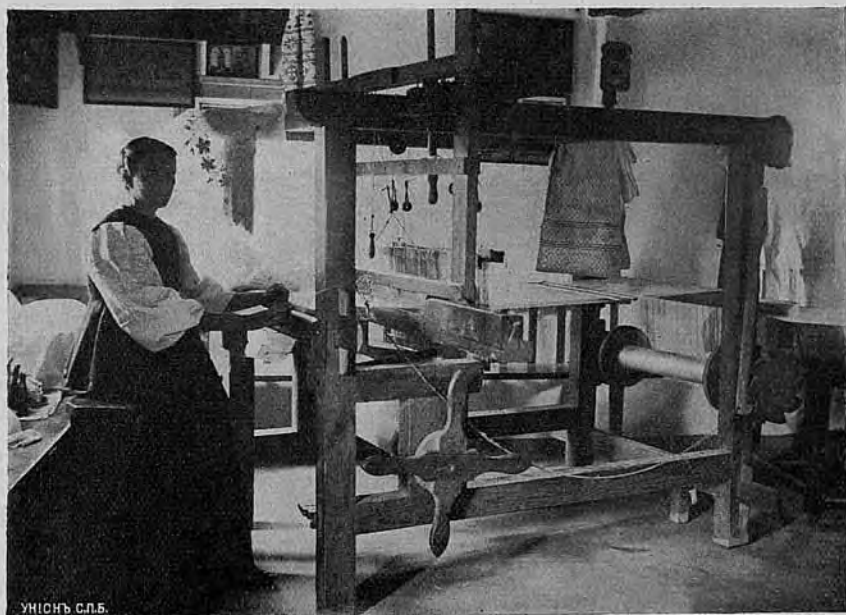
Рис. 32. Ткачиха, работающая шелковую ткань съ переборнымъ узоромъ цвѣтами. Прилукскаго уѣзда Полтавской губ.
