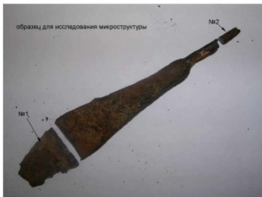
Рис. 26. Зоны для исследования микроструктуры изделия.
